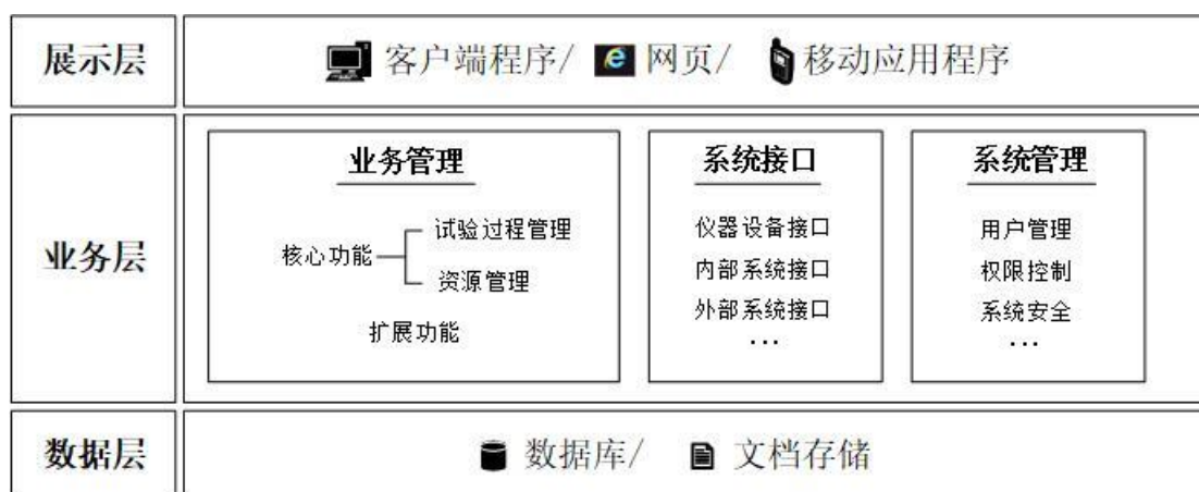
图2 实验室信息管理系统（LIMS）结构
